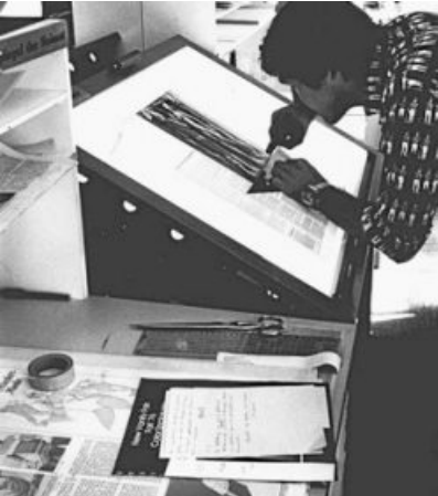
Der Abschied vom Bleisatz bringt neue Aufgaben mit sich. Jetzt werden die Artikelfahnen abends auf eine leere Zeitungssseite geklebt. Weiter gilt: Alles muss exakt passen.
