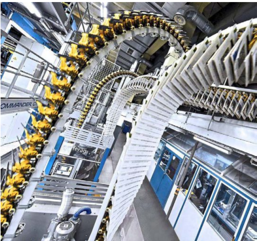
Der Aufbruch in ein neues Zeitungs-Zeitalter bringt am 11. März 2012 dank einer neuen Druckmaschine auch ein neues, handlicheres BNN-Format. In der zehn Meter hohen und 30 Metern langen Anlage in Neureut wird die Papierbahn mit einem Tempo von 12,75 Metern pro Sekunde gedruckt und verarbeitet. Fotos (7): Rake Hora
